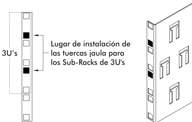
Sub-Racks con 3U's de altura
