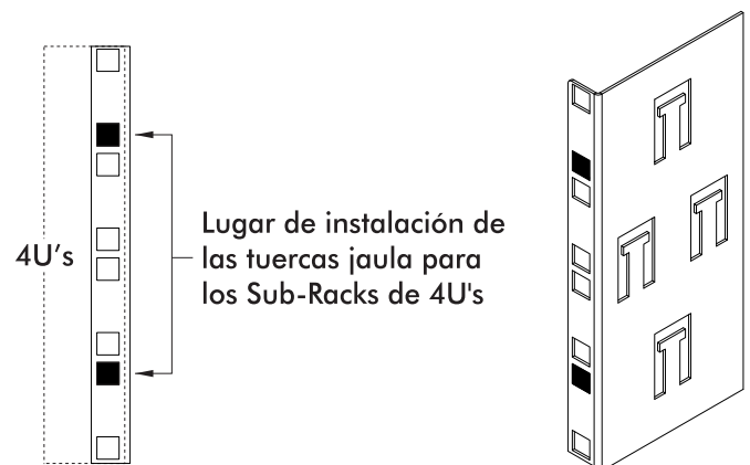
Sub-Racks con 4U's de altura
