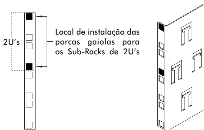
Sub-Racks com 2U's de altura
